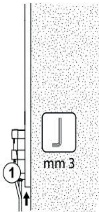
**ITA** - Dopo aver correttamente posizionato la colonna sulle rispettive staffe di supporto e bloccaggio, avvitare la vite anti-estrazione (1) come indicato in Fig. 6.
