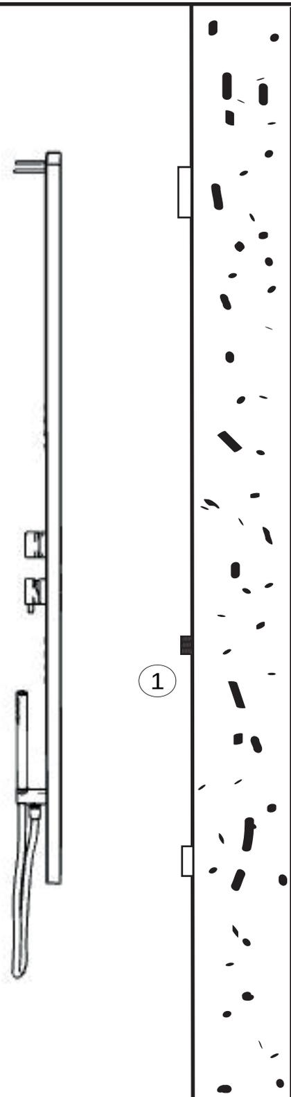
**ITA** - Solo dopo aver eseguito l'allacciamento idraulico, e verificato la tenuta dello stesso, procedere alla messa in sede della colonna doccia come indicato in Fig. 5, prestando attenzione che l'aletta inclinata (1) entri completamente nell'apposita sede della flangia superiore (2) e che il foro (3), presente nella parte inferiore del corpo esterno della colonna doccia, coincida con il foro della staffa di fissaggio inferiore (4).
