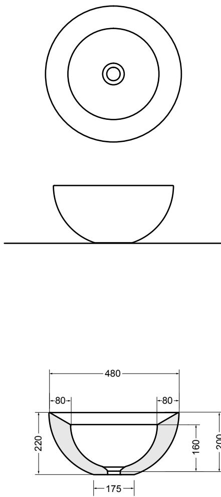
N.B.: Le misure indicate possono subire una variazione dello 0,8 % circa, dovuta ad usura stampi o a piccole variazioni delle caratteristiche tecniche relative alle materie prime che compongono l' impasto.
