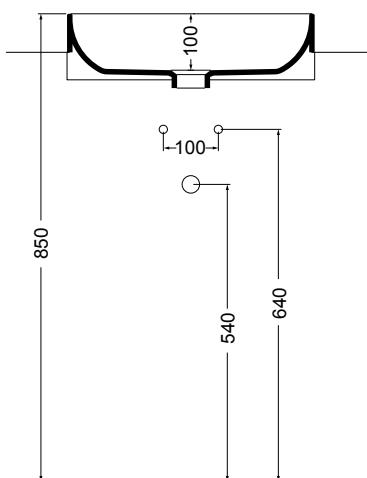
N.B.: Le misure indicate possono subire una variazione dello 0,8 % circa, dovuta ad usura stampi o a piccole variazioni delle caratteristiche tecniche relative alle materie prime che compongono l' impasto.
