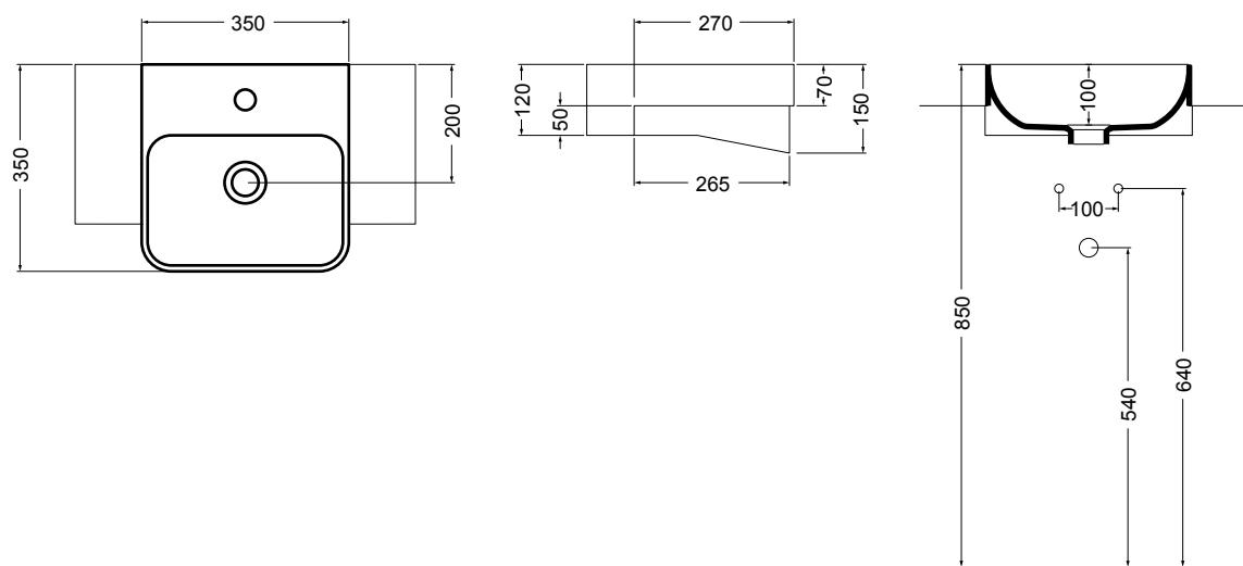
N.B.: Le misure indicate possono subire una variazione dello 0,8 % circa, dovuta ad usura stampi o a piccole variazioni delle caratteristiche tecniche relative alle materie prime che compongono l' impasto.
