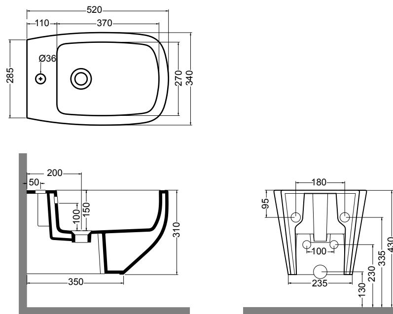
N.B.: Le misure indicate possono subire una variazione dello 0,8 % circa, dovuta ad usura stampi o a piccole variazioni delle caratteristiche tecniche relative alle materie prime che compongono l' impasto.
