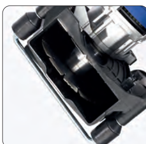
Larghezza di taglio regolabile 0,7 - 5 cm (con 2 dischi)
